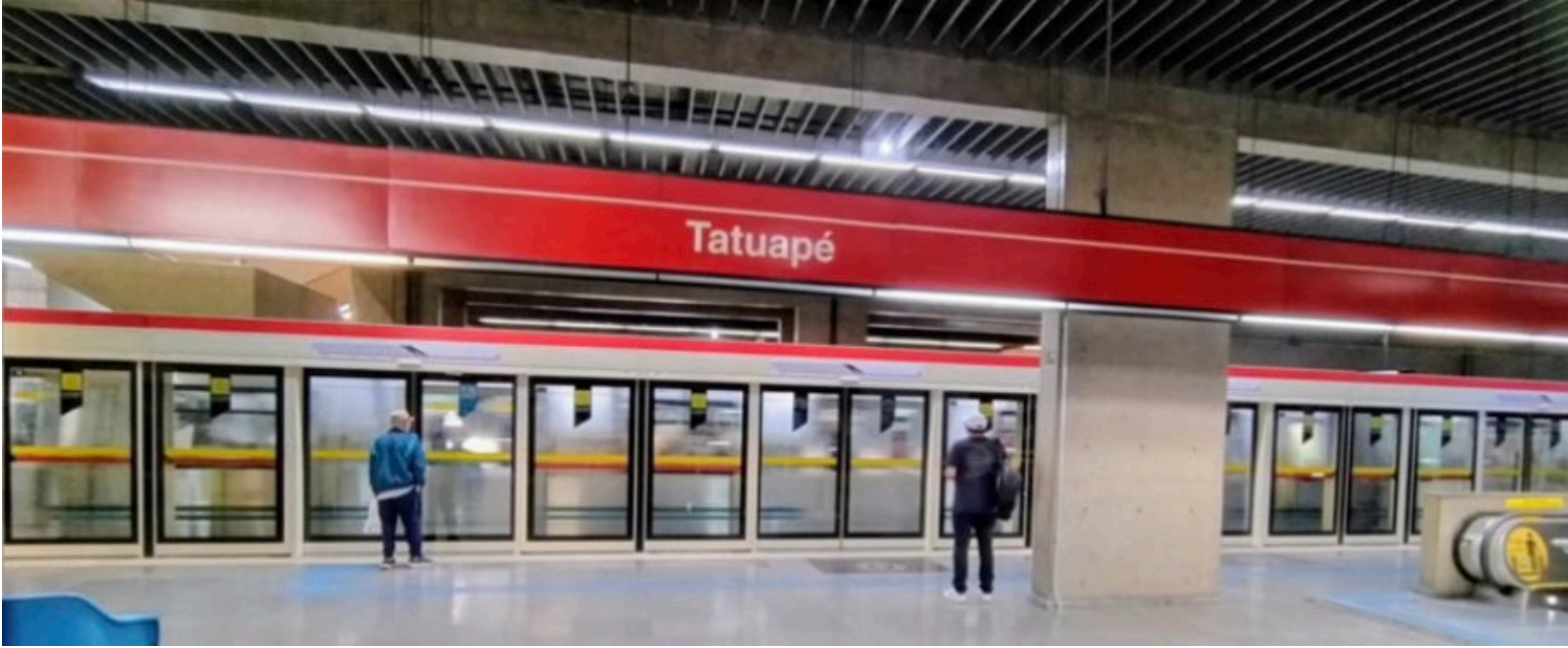
Foto: portas de plataforma da Estação Tatuapé
